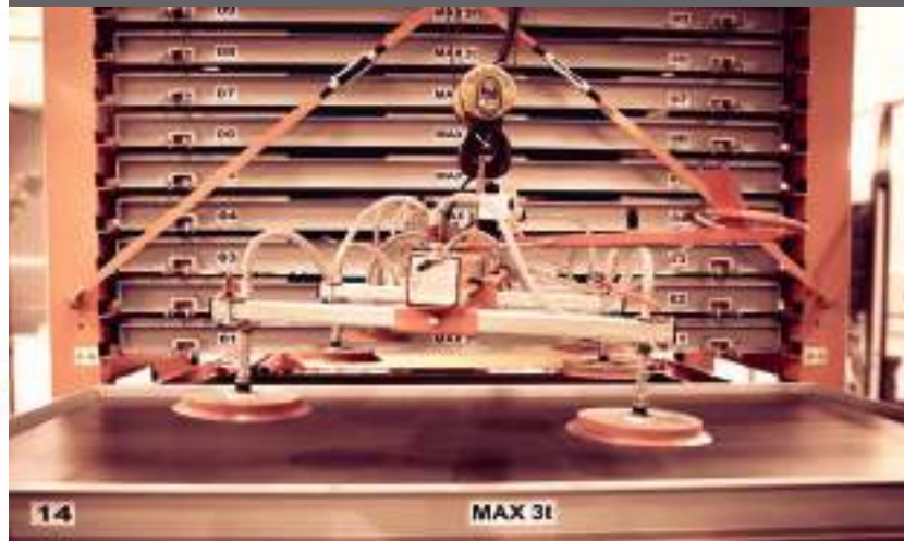
MANUTENTION PAR GRUE ET PALONNIER À VENTOUSE
